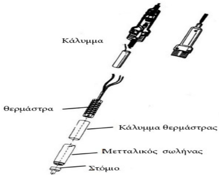
Σχηματική απεικόνιση του συγκολλητικού σιδήρου (ανεμιστήρας με κινητήρα χωρίς ψήκτρες)
